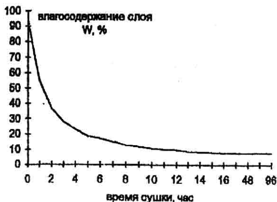
Рис. 2. Зависимость влагосодержания эмульсионного слоя от времени сушки
