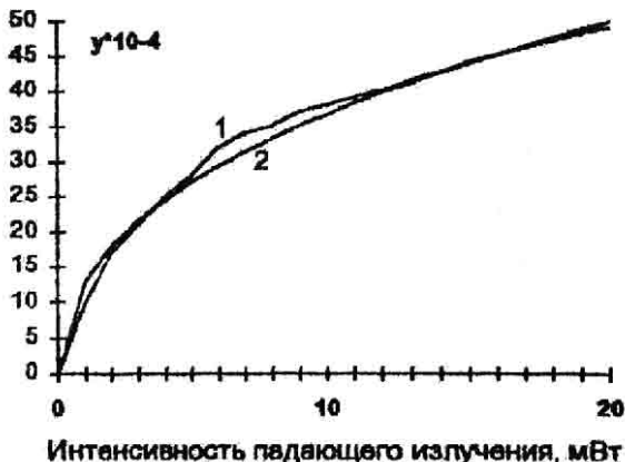
Рис. 9. Зависимость параметра \gamma от интенсивности падающего излучения 1-экспериментально вычисленная кривая 2-график кривой \gamma = \gamma I^{0,45}
