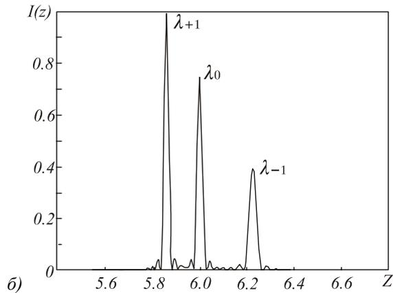
Рис.2. (а) Зонная пластинка для разделения длин волн  $\lambda_0=0.63\mu\text{м}$ ,  $\lambda_{+1}=5\lambda_0/6$ ,  $\lambda_{-1}=5\lambda_0/4$  по трем фокусам, (б) Распределение интенсивности на оптической оси.
