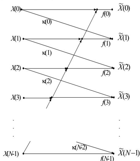
Рис. 2. Схема прямого преобразования Агаяна-Айзенберга
