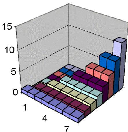
Рис. 1. Графическое представление базисных функций ОАА-преобразования при  $N = 8$ .
