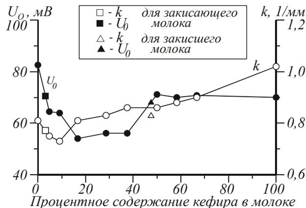
Рис. 3. Зависимости параметров рассеяния  $U_0$  и  $k$  от процентного содержания кефира в молоке.
