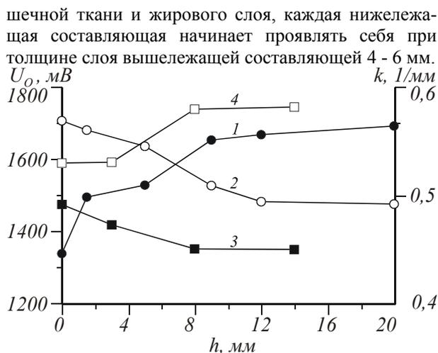
Рис. 7. Зависимости параметров рассеяния  $U_0$  (1, 3) и  $k$  (2, 4) от толщины  $h$  вышележащей составляющей двухслойной структуры, состоящей из мышечной ткани и жирового слоя свинины. 1, 2 – нижележащей составляющей является мышечная ткань; 3, 4 – нижележащей составляющей является жировой слой.
