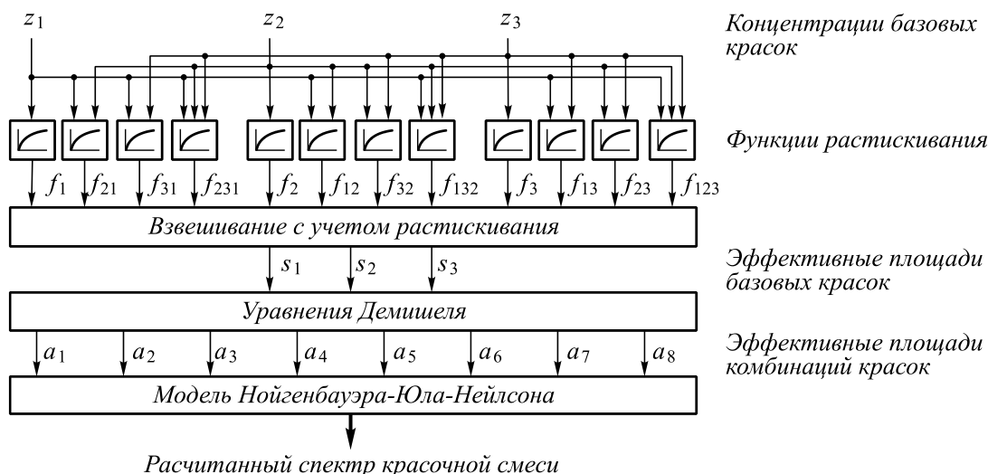
Рис. 2. Схема применения модели Нойгебауэра-Юла-Нейлсона с учетом растискивания
