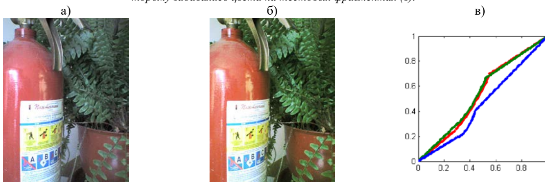
Рис. 3. Исходное (а) и скорректированное (б) изображения при отсутствии похожих изображений; кривые преобразования цветных координат (в).
