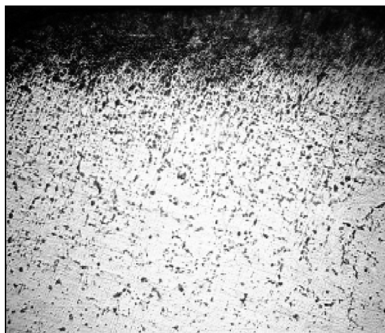
Рис. 4. Структура приповерхностного слоя медно-цинкового сплава Л62 после проведения лазерного воздействия: увелич. \times 500 . Протравленный и повторно полированный шлиф
