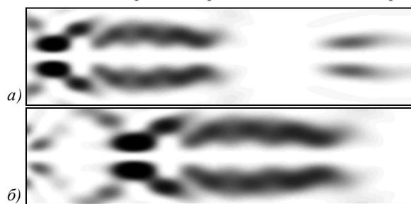
Рис. 10. Продольные распределения интенсивности (негатив) при освещении амплитудного ДОО лазерным пучком ТЕМ<sub>01</sub> с  $\lambda = 1,064$  мкм в расчётном случае (а) и при наличии слаборасходящегося сферического фронта  $\beta = 1,6 \text{ мм}^{-2}$  (б) на отрезке оптической оси  $z \in [180 \text{ мм}, 280 \text{ мм}]$ ,  $x \in [-0,1 \text{ мм}, 0,1 \text{ мм}]$
