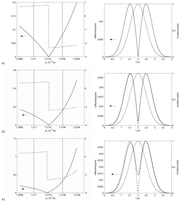
Рис. 2 . Левая колонка: модуль (непрерывная линия) и аргумент (пунктирная линия) коэффициента отражения решётки. Вертикальным пунктиром отмечен использованный в расчёте спектральный интервал  $|\omega - \omega_0| < \Omega$ ,  $\Omega = 4,25 \cdot 10^{12} \, \mathrm{c}^{-1}$
