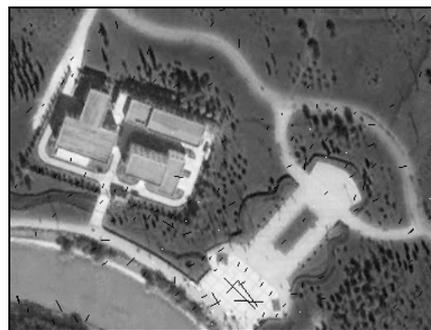
Рис. 3. Результат установления соответствия между SIFT-точками изображений с рис. 1
