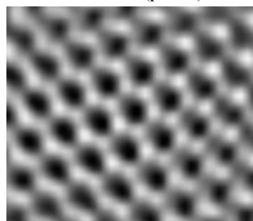
Рис. 1. Изображение графена с гексагональной кристаллической решёткой, полученное в электронном микроскопе высокого разрешения, сторона гексагона – 2,5\text{Å} , расстояние между атомами углерода (светлые пятна) – 1,44\text{Å} [7]
