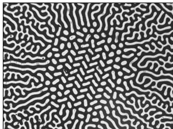
Рис. 3. Доменная структура на начальной стадии формирования упорядоченной 2D структуры
