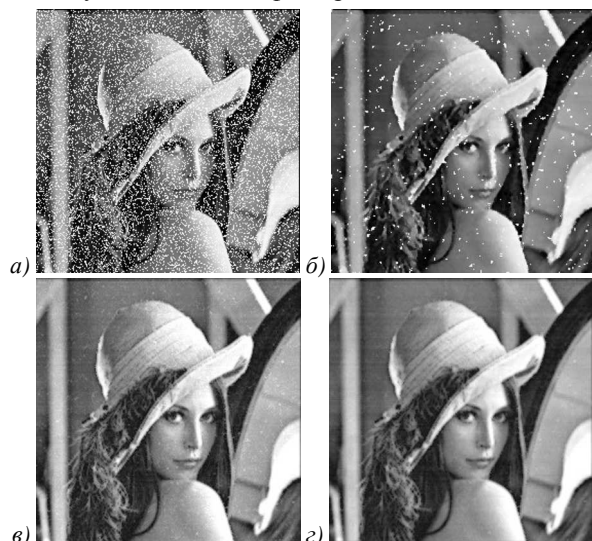
Рис. 8. Результаты фильтрации изображения «Лена»: (а) изображение, искажённое импульсным шумом с вероятностью p = 0,2 ; (б) результат медианной фильтрации с маской 3 \times 3 ; (в, г) результаты последовательной нелинейной фильтрации с величинами порога a , равными соответственно 70 и 30
