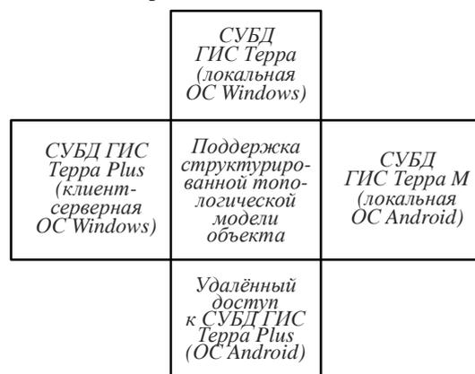
Рис. 9. Структура взаимосвязи СУБД для разных платформ
