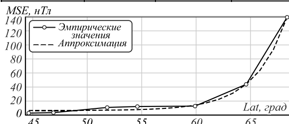
Рис. 5. Зависимость погрешности восстановления данных от географической широты магнитной обсерватории
