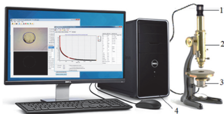
Рис. 1. Прибор для изучения набухания полимерных гелей (ПГ) методом оптической микрометрии. 1 – видеокамера, 2 – оптический микроскоп, 3 – источник света, 4 – ПК, снабженный необходимым пакетом программ
