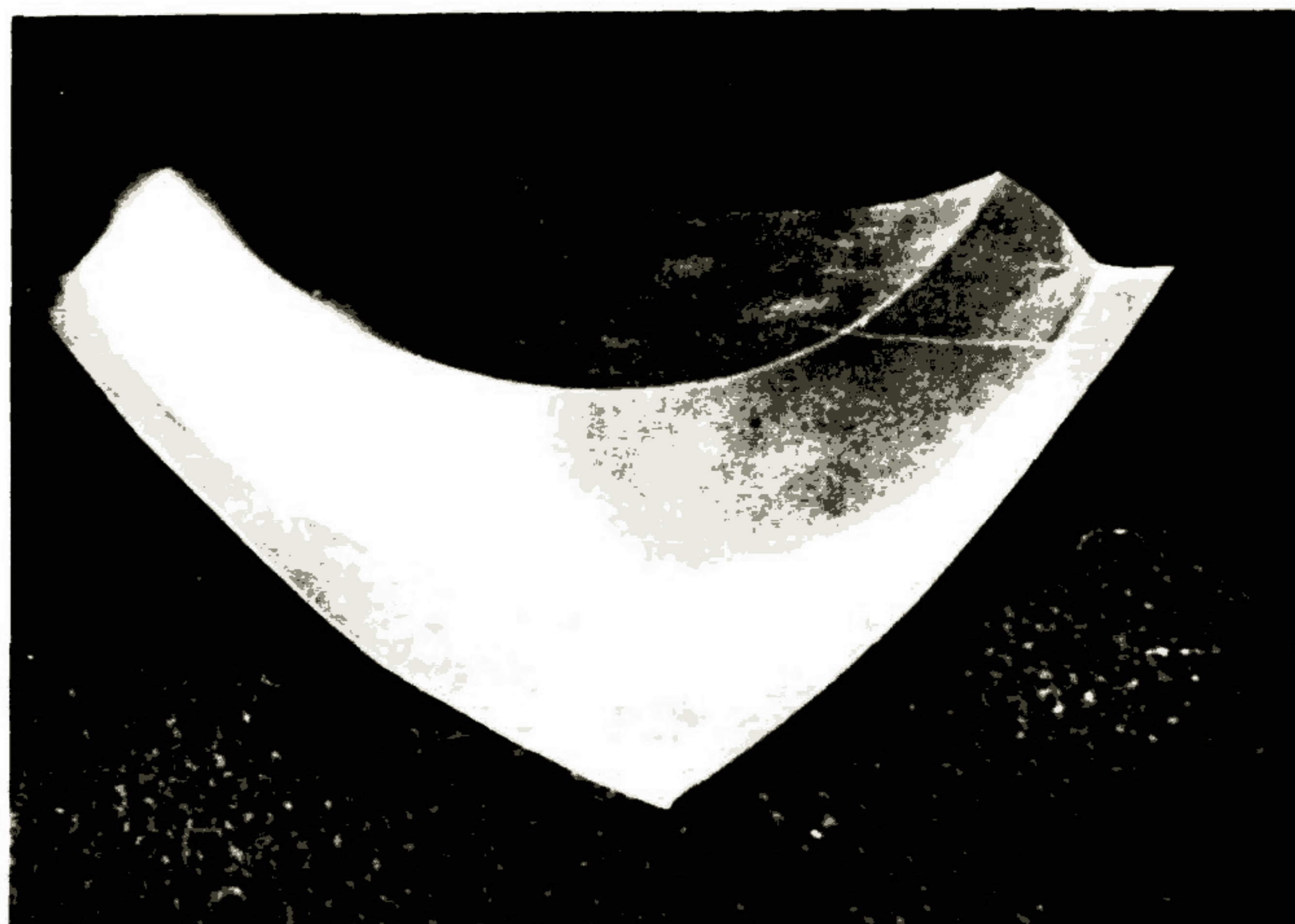
Рис. 1. Общий вид детали из алюминиевого сплава АМГ2Н, полученной гибкой по криволинейному контуру предварительно отожженной заготовки
