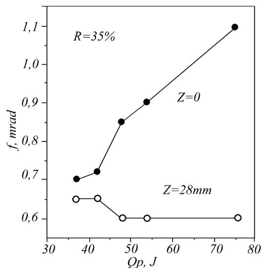
Рис.5. Зависимость расходимости лазерного излучения  $f$  от энергии импульсов накачки  $Q_p$ .
