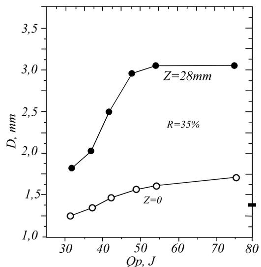
Рис. 4.- Зависимость диаметра выходного лазерного пучка  $D$  от энергии импульсов накачки  $Q_p$ .
