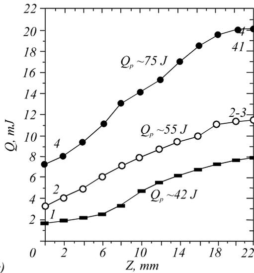
Рис.2. Зависимость энергии импульсов генерации  $Q$  одномодового лазера с АПР от положения нелинейной среды  $Z$  в резонаторе при различных энергиях импульсов накачки. Коэффициенты отражения выходного зеркала резонатора составляли 18% (а); 26% (б); 35% (в) и 55% (з).
