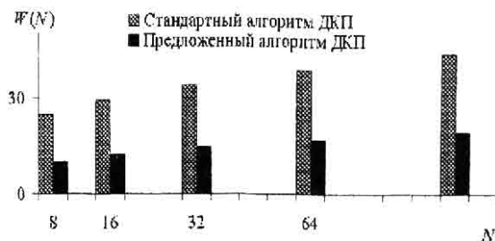
Рис. 2. Сравнение сложности традиционного и предложенного алгоритма ДКП
