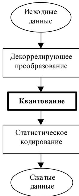
Рис. 1. Структурная схема работы алгоритмов компрессии.
