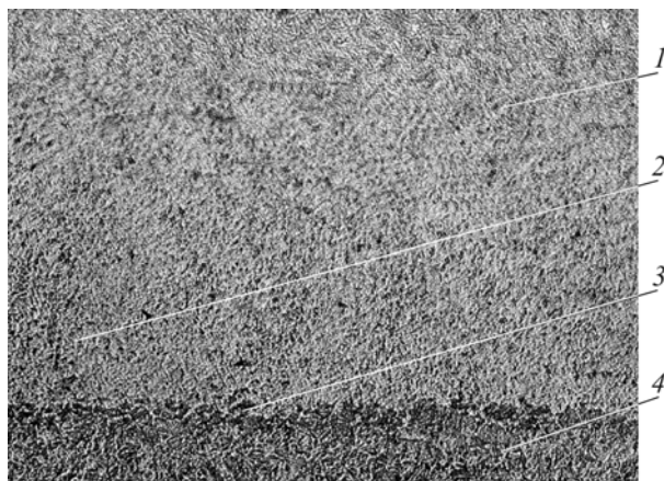
Рис. 9. Структура области лазерного воздействия после термоупрочнения среднеуглеродистой стали 40Х: увелич. x30: 1 – закаленная зернистая структура мартенситного типа; 2 – область неполной закалки; 3 – переходная зона; 4 – исходная структура
