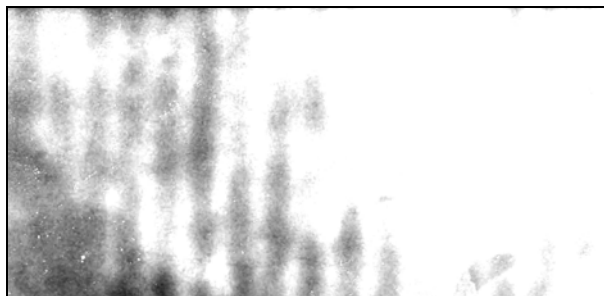
Рис. 4. Фотография распределения интенсивности светового потока в ЖК ячейке с разрешением решетки 200 л/мм
