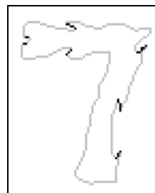
Рис. 6. Объект с изломанным контуром. Черным помечены точки с аномальной ориентацией направления обхода
