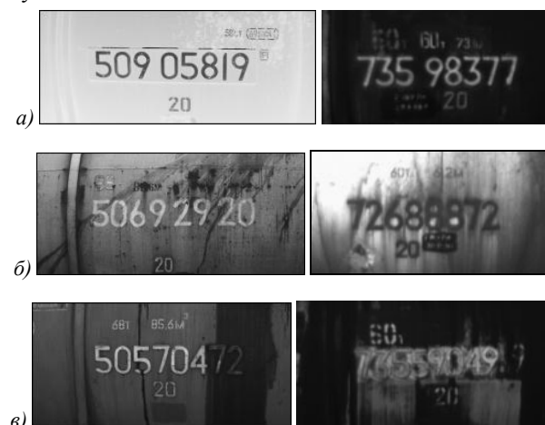
Рис. 2. Примеры номеров цистерн с разной степенью загрязнения: а) чистые, б) умеренно загрязненные, в) сильно загрязненные
