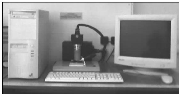
Рис. 3. Внешний вид автоматизированного устройства анализа микро- и наносероховатостей поверхности подложки
