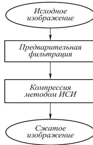
Рис. 2. Схема ИСИ-компрессии с предварительной фильтрацией
