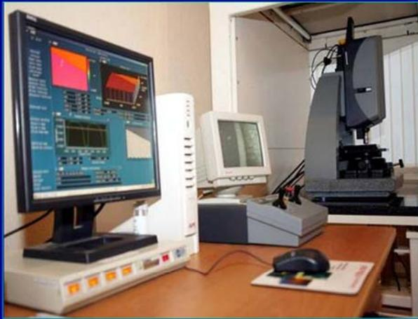
**NEWVIEW 5000 обеспечивает контроль микрорельефа на участках размером до 20x20см.**
