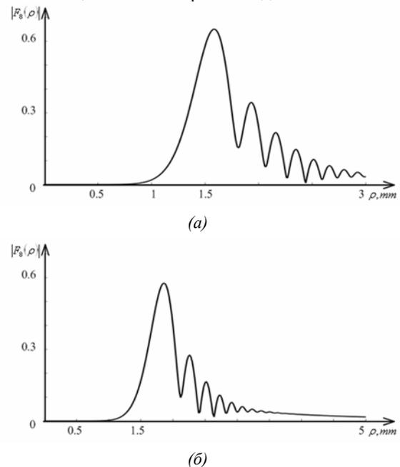
Рис. 2. Радиальный профиль картины дифракции Френеля (амплитуда  $|F_n(\rho, \theta)|$ ) Гауссова пучка ( $\lambda = 633$  нм,  $w = 1$  мм) на СА ( $n = 8$ ,  $\alpha = 20$  мм<sup>-1</sup>):  $z = 400$  мм (а),  $z = 500$  мм (б)
