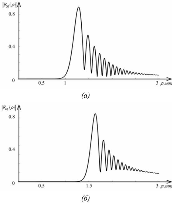
Рис. 3. Радиальный профиль картины дифракции Френеля (амплитуда  $|F_n(\rho, \theta)|$  на расстоянии  $z = 200$  мм) Гауссового пучка ( $\lambda = 633$  нм,  $w = 1$  мм) на СА ( $\alpha = 20$  мм<sup>-1</sup>):  $n = 20$  (а),  $n = 40$  (б)
