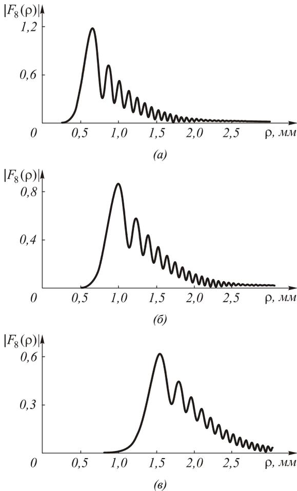
Рис. 1. Радиальный профиль картины дифракции Френеля (амплитуда  $|F_n(\rho, \theta)|$ ) на расстоянии  $z = 200$  мм для Гауссова пучка ( $\lambda = 633$  нм,  $w = 1$  мм) на СА ( $n = 8$ ):  $\alpha = 0$  мм<sup>-1</sup> (а),  $\alpha = 20$  мм<sup>-1</sup> (б),  $\alpha = 50$  мм<sup>-1</sup> (в)
