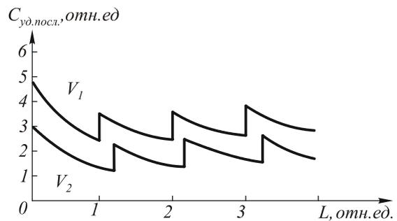
Рис. 7. Зависимости удельной стоимости последовательного ОК от длины канала  $v1, v2$  - скорость передачи; ОК - оптоэлектронный канал;  $C_{\text{уд. посл.}}$  - удельная стоимость последовательного оптоэлектронного канала
