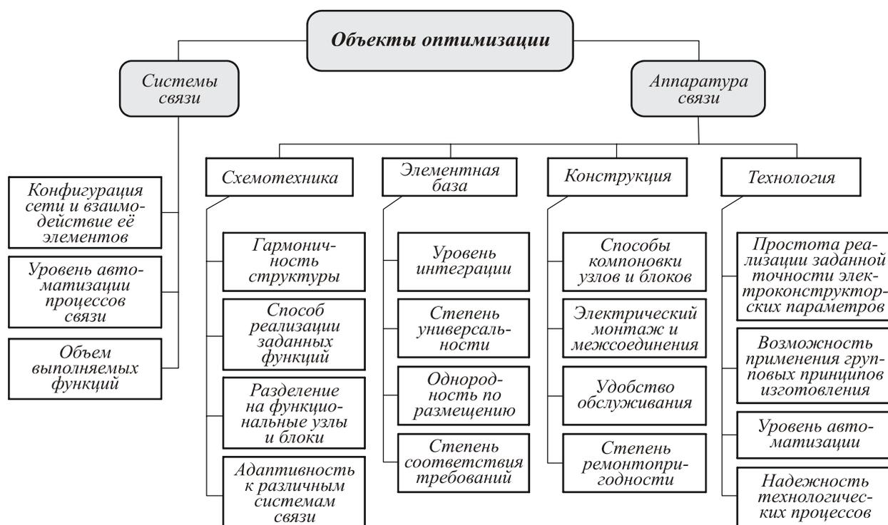
Рис. 2. Основные направления оптимизации систем и аппаратуры вычислительных сетей
