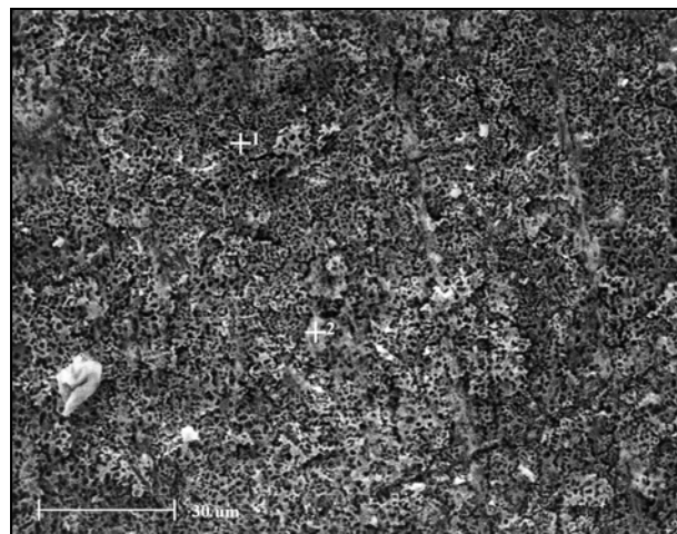
Рис. 4. Структура поверхностного слоя после лазерного воздействия на образец
