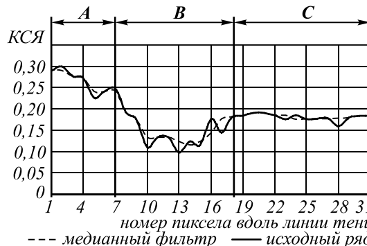
Рис. 5. Профиль значений КСЯ в ближнем ИК канале MODIS по линии тени от облака. Зоны линии тени: А – зона остаточной облачности, Б – область тени, В – область избыточно выделенной тени
