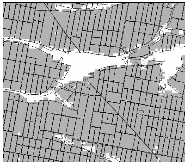
Рис. 10. Фрагмент маски ИПЗ (серый) с векторными границами полей (чёрный), используемыми для оценки точности классификации
