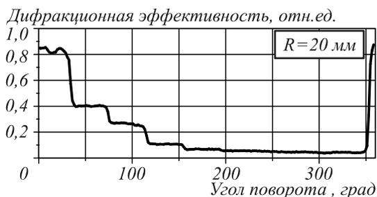
Рис. 8. Зависимости дифракционной эффективности аттенюатора от угла поворота (метод пространственной калибровки)
