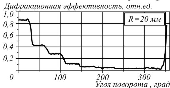
Рис. 10. Зависимости дифракционной эффективности аттенюатора от угла поворота (метод временной калибровки)
