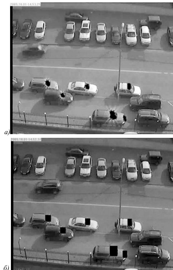
Рис. 4. Примеры обнаруженных бликов: алгоритмом активного контура (а); алгоритмом на основе функции контраста (б)
