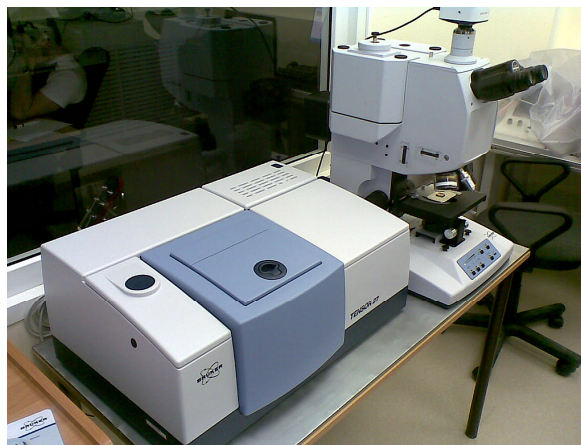
Рис. 3. ИК-микроскоп HYPERION 1000, сопряжённый с ИК-Фурье спектрометром Tensor 27
