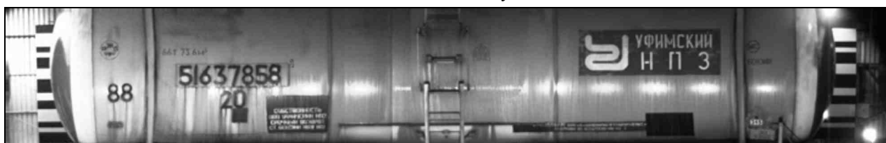
Рис. 7. Результат работы технологии прагматической компрессии – синтезированный панорамный снимок вагона
