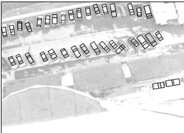
Рис. 1. Пример работы системы обнаружения легковых транспортных средств
