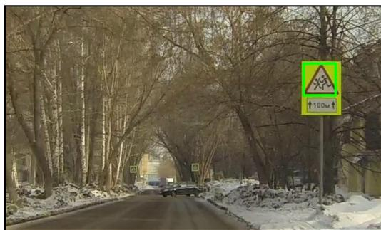
Рис. 5. Фрагмент кадра с отмеченным дорожным знаком
