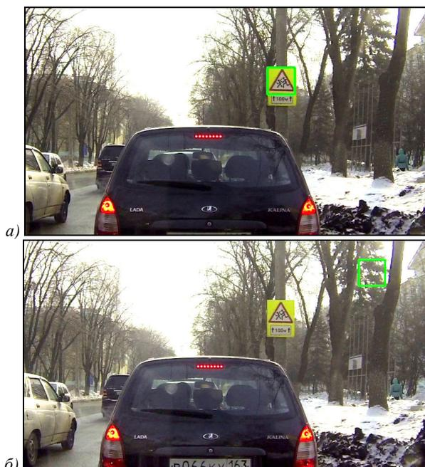
Рис. 6. Пример правильного детектирования знака (а), пример ошибки детектирования (б)
