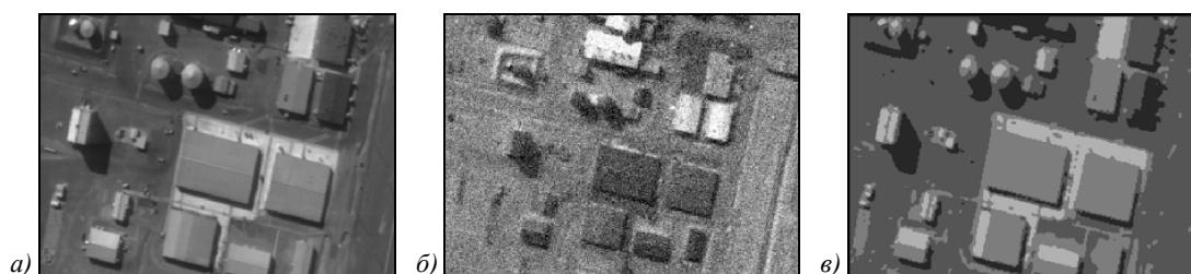
Рис. 3. Пример 1: эталонный ТВ-фрагмент (а); тестовое ИК-изображение (б); сегментированный ТВ-фрагмент (в)
