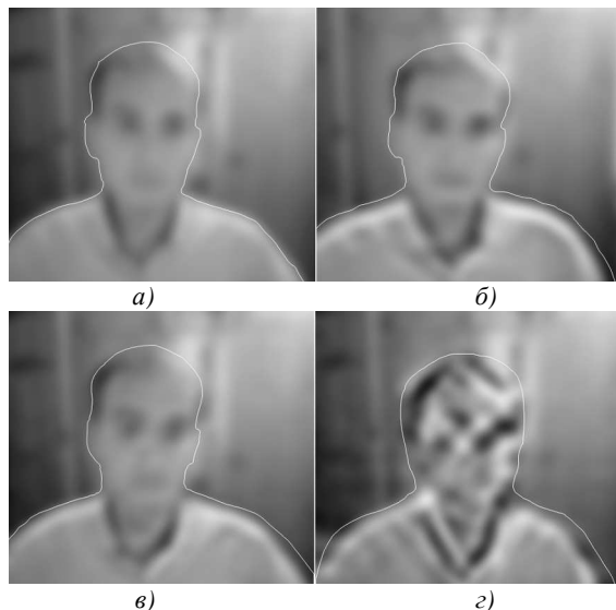
Рис. 9. Изменение контуров грудной клетки человека при дыхании для обычного видеопотока (а), для видеопотока, к которому применили усиление движений с коэффициентом усиления k = 2 (б), k = 6 (в), реакция на слабые покачивания всего тела человека при k = 16 (г)
