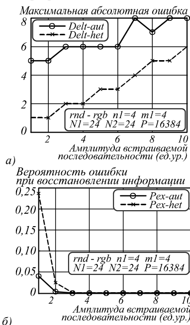
Рис. 7. Зависимости максимальной абсолютной ошибки (а) и вероятности ошибки восстановления информации (б) от амплитуды встраиваемой последовательности ЦВЗ
