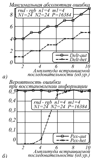
Рис. 8. Зависимости максимальной абсолютной ошибки (а) и вероятности ошибки восстановления информации (б) от амплитуды встраиваемой последовательности ЦВЗ
