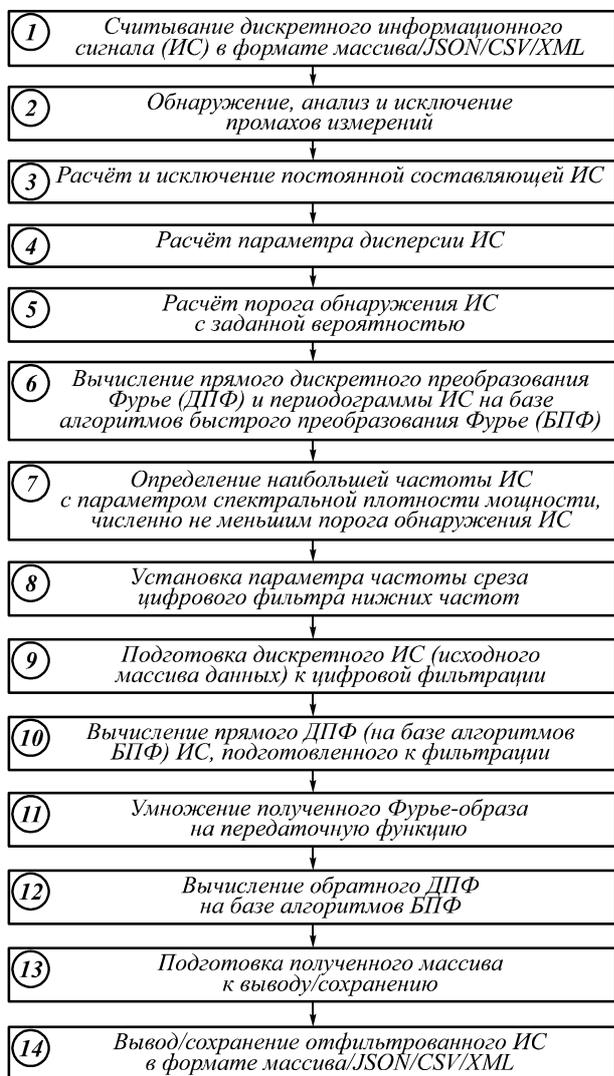
Рис. 3. Методика цифровой обработки информационного сигнала (ИС – информационный сигнал)
