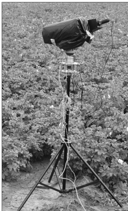
Рис. 2. Внешний вид гиперспектрометра на вращающейся установке для полевых исследований
