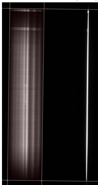
Рис. 4. Вид спектрального распределения, зарегистрированного на светочувствительной матрице, для одного положения гиперспектрометра
