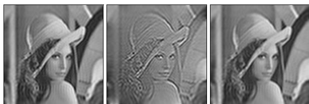
Рис. 23. Аппроксимация исходного изображения (а); результат восстановления изображения по фазе АПФЭ после 100 итераций (б); после 2000 итераций (в)
