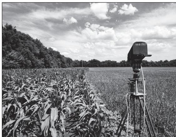
Рис. 1. Получение гиперспектральных изображений растительности при помощи сканирующего гиперспектрометра на поворотной платформе
