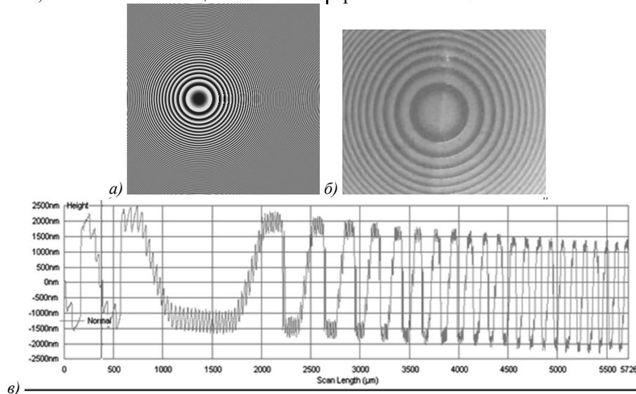
Рис. 1. Фазовая функция СДЛ (735 нм, 835 нм) (а), внешний вид центрального участка СДЛ (735 нм, 835 нм) с тонкой структурой под оптическим микроскопом (б), профилограмма СДЛ (735 нм, 835 нм), полученная вдоль линии симметрии линзы в профилометре Tencor (в)
