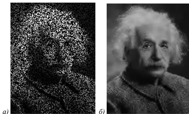
Рис. 3. Пример восстановления изображения: а) зашумленное изображение, б) восстановленное с помощью словаря на основе дискретного косинусного преобразования
