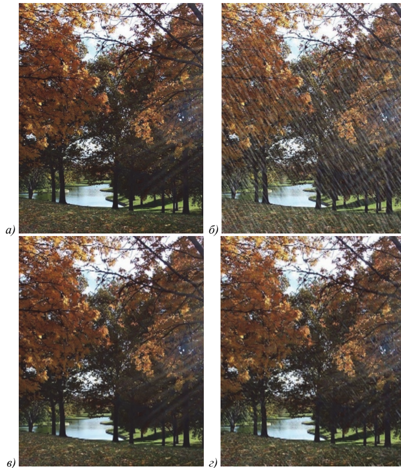
Рис. 5. Улучшенные фрагменты изображения из погодного датасета: а) исходное изображение; б) изображение с каплями дождя; в) улучшенное изображение при R=1 ; з) улучшенное изображение при R=8
