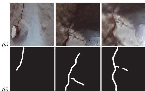
Рис. 2. Примеры изображений трещин стальных конструкций и их бинарных масок
