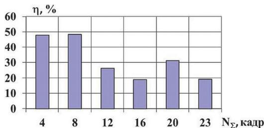
Рис. 11. Эффективность работы ( $\eta$ ) помехоустойчивого алгоритма post-обработки изображений по отношению к способу последовательной обработки видеопотока в зависимости от количества накопленных разностных изображений ( $N_{\Sigma}$ )
