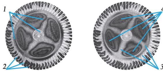
Рис. 1. Интерференционная картина колебаний рабочего колеса компрессора ГТД на близких частотах [12]: а) 1247 Гц б) 1254 Гц. 1 – диск рабочего колеса; 2 – лопаточный венец; 3 – зона узла колебания рабочего колеса (светлая интерференционная полоса нулевого порядка); 4 – зона пучности
