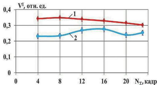
Рис. 10. Сравнительное изменение видности интерференционных картин зависимости от количества накопленных разностных изображений ( $N_{\Sigma}$ ) при использовании разных алгоритмов обработки: 1 – способ post-обработки; 2 – способ последовательной обработки видеопотока
