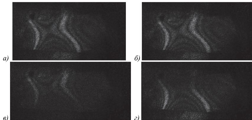
Рис. 6. Характерные разностные изображения приемлемого качества: а, б) высокий контраст интерференционной картины (значение видности: а)  $V^I = 0,408$ ,  $\Delta N = 13$  кадров; б)  $V^I = 0,453$ ,  $\Delta N = 8$  кадров); в) частичная потеря информации в нижней части пера лопасти вентилятора; г) частичная потеря информации в верхней части пера лопасти вентилятора. Яркость представленных изображений увеличена в 3 раза по сравнению с исходным состоянием
