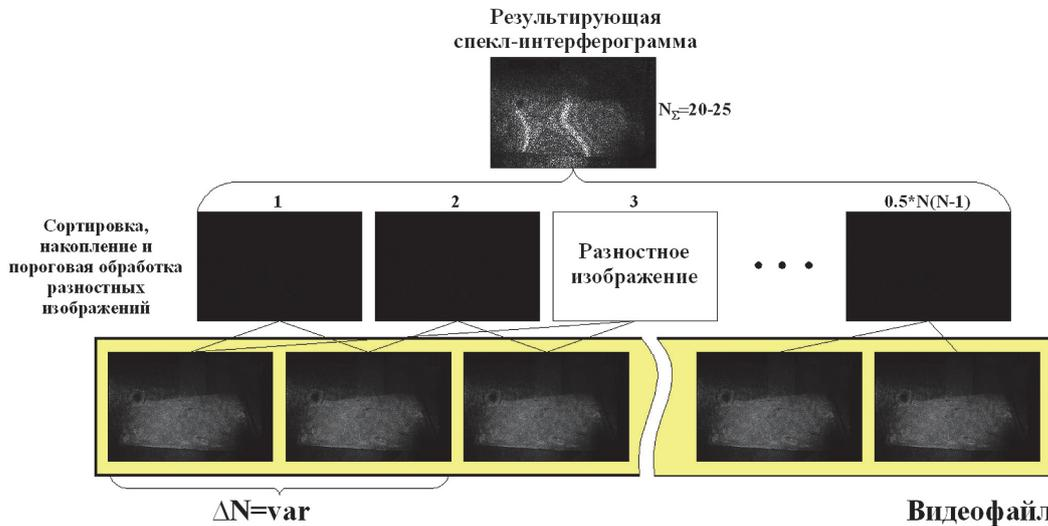
Рис. 5. Схема получения результирующей спекл-интерферограммы колеблющегося объекта при post-обработке видеофайла.  $N$  – количество использованных кадров в видеофайле.  $\Delta N$  – переменное расстояние между выбранными кадрами в видеофайле
