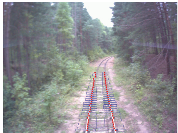
Рис. 5. Кадр видеоизображения с камеры БПЛА с наложенными на него секторами \Omega_{i,j} , которые показаны синими прямоугольниками, положение точки с максимумом сигнала в каждом секторе обозначены красными кружками
